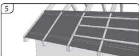
6. Následující pás membrány uložte s přesahem 10 – 15 cm (viz tabulka níže). Pro správnou montáž a zabezpečení těsnosti spojů použijte Střešní fixační pásku DB membrána nebo DB FLEX.
