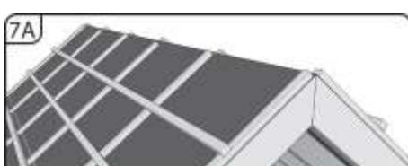
7. U neodvětraných střech membrána prochází přes hřeben za účelem zabezpečení těsnosti před sněhem a deštěm (7A). U odvětrávaných střech se střešní membrána musí ukončit 5 cm pod nejvyšším bodem hřebenu (7B). Vzniklý ventilační otvor je potřeba dodatečně překryt pásem membrány zajišťeným kontralatěmi tak, aby přesahoval přes membránu min. 20 cm.
