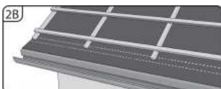
3. Membránu ukotvíme ke krovu pomocí nerezových hřebíků nebo sponkami, a to vždy v místech přesahu a nad spojením páskou. Kotvení do krokví provádějte nejlépe ve středu krokve, aby kontralat' s těsnící páskou překryla kotvící prvky.
