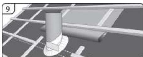
9. V případě menších prvků (např. Odvětrání šachet) membránu nařežte ve tvaru lichoběžníku a trvale připevněte k latím.
