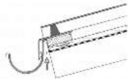
Výstup ventilační spáry u hřebenu musí vést nad plochu střešního pláště tak, aby výška výstupu byla alespoň 15 cm.
