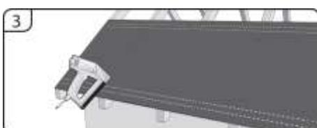
4. Za účelem zabezpečení těsnosti na krovkách nebo bednění a zabránění průniku vody doporučujeme nalepit těsnící pásku na spodní stranu kontralatí, která dotlačí fólii na krov a zajistí dotěsnění kotvících prvků. Pozor na sníženou přilnavost mokrých a nečištěných ploch.
