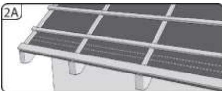
2. V oblasti okapu musí být membrána namontovaná pod kontralatěmi a okapová lat' na okapovém plechu (2A), nebo nad okapovou lat' na svodovém plechu do okapu (2B). Vyvarujte se tvoření protispádů a ohybů, ve kterých by se mohla držet voda. Napojení membrány na okapový plech se doporučuje za pomocí Butylové pásky.
