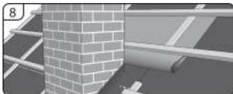
8. Pro prvky vystupující ze střechy (komín, střešní okna) membránu nařízněte, vytáhněte ji a připevněte např. pomocí butylového pásku. Nad daným prvkem vytvořte okapový žlab z dostatečného kusu membrány. Horní konec vložte pod nejbližší pás membrány a spodní konec srolujte směrem nahoru a přibijte k lati nad překážkou. Spád ze žlabu vyvědeť mimo překážky.
